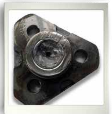
PUNTO DE ARTICULACIÓN DE EJE NO ORIGINAL
