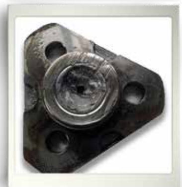
PUNTO DE ARTICULACIÓN DE EJE NO ORIGINAL
